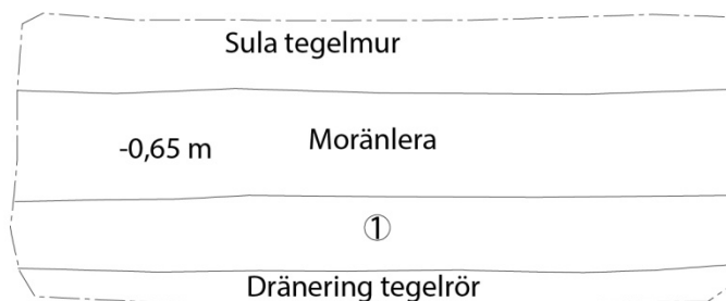
Figur 8. Planritning över den östra provgropen. Den var ca 2,00 m lång, ca 1,00 m bred och ca 0,60- 0,65 m djup. Dess östra sida utgjordes av källarmuren och längs dess västra löpte en dräneringsledning. Fyllningen i nedgrävningen markerat med 1 bestod av ett kulturpåverkat lager som var gråbeige, kompakt, lerigt, finkornigt och fuktigt. Innehåller stråk av gul lera, träkol, enstaka småbitar av lerklina och enstaka sniglar/snäckor.
